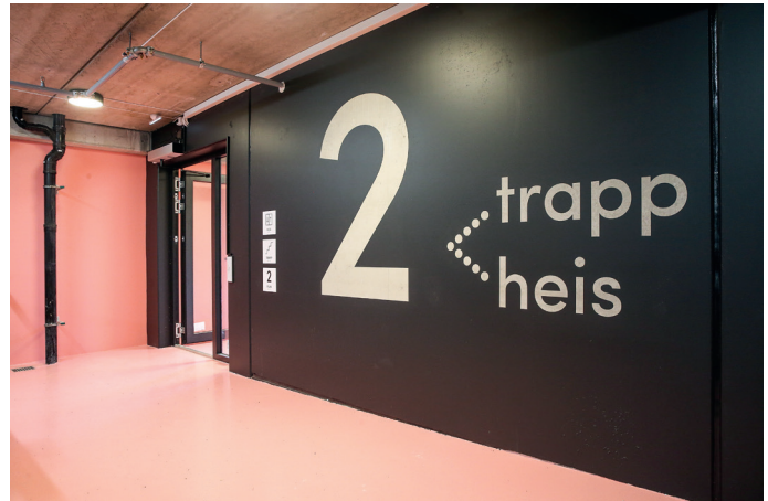
Betongelementene er malt på innsiden i Passasjen. PU-belegget på gulvet og maling på vegger har ulike farger i hver etasje. Andre etasje er farget rosa.
